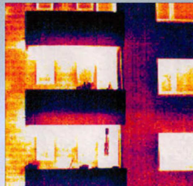
Растительный налет на всех холодных поверхностях декоративного покрытия фасада: левая часть объекта (с балконами) — с теплоизоляцией, правая часть объекта (без балконов) — без теплоизоляционной системы
